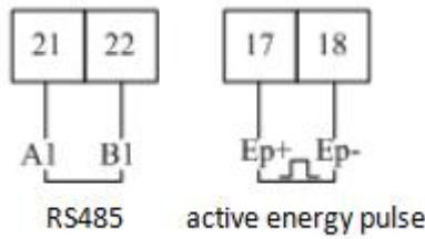
图 4 通讯、脉冲接线
